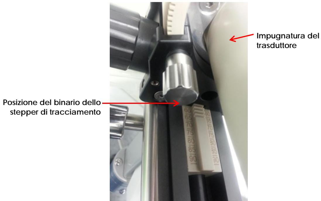
Figura 40: Posizione del binario dello stepper di tracciamento
