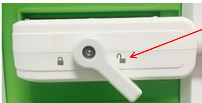
Manopola di bloccaggio sul connettore del trasduttore (in posizione di sblocco)
